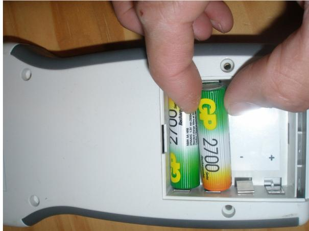
La mise en place est facilitée en plaçant en premier le côté '+' de la pile dans son logement.
