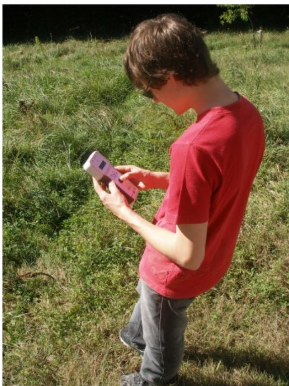
Vous devez vous positionner face au Soleil de manière stable et amener rapidement le point lumineux au milieu de la cible du pointeur et de l'y maintenir le temps des mesures.
